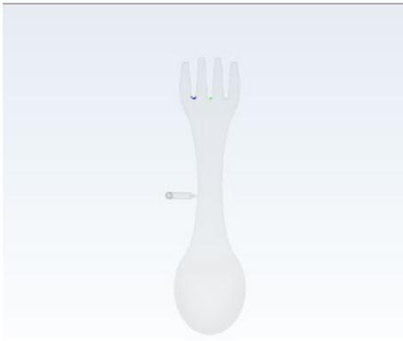
Gambar 10. Cacat *weld line* lokasi *gate* 3.
