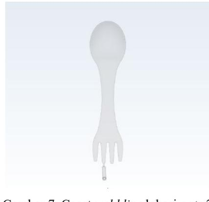
Gambar 7. Cacat *weld line* lokasi *gate 2*
