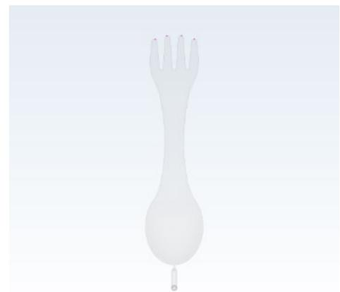
Gambar 3. Cacat *air traps* lokasi *gate* 1
