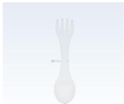
Gambar 9. Cacat *air traps* lokasi *gate 3*.
