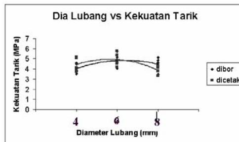
Gambar 11. Pengaruh diameter lubang dibor dan dicetak terhadap kekuatan tarik komposit
