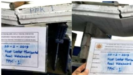
Gambar 6. Pola kerusakan yang terjadi pada panel *polystyrene* dengan perkuatan *kalsiboard* (PPK )
