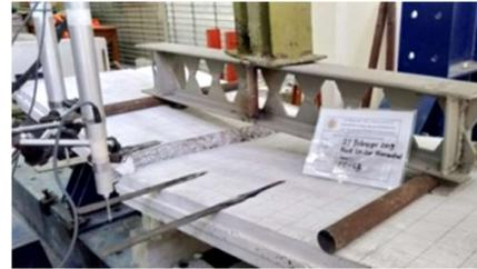
Gambar 3. Panel *polystyrene* tanpa perkuatan (PPL) setelah diuji
