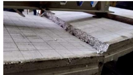
Gambar 4. Pola patah pengujian kuat lentur horisontal pada panel *polystyrene* tanpa perkuatan (PPL)
