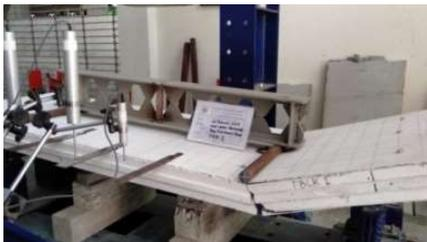
Gambar 7. Kerusakan uji lentur horisontal pada panel *polystyrene* dengan perkuatan dengan sambungan baut (PBK)
