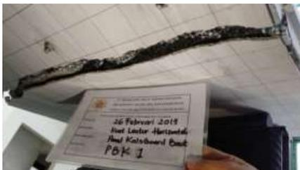
Gambar 8. Pola kerusakan yang terjadi pada panel *polystyrene* dengan perkuatan dengan sambungan baut (PBK)
